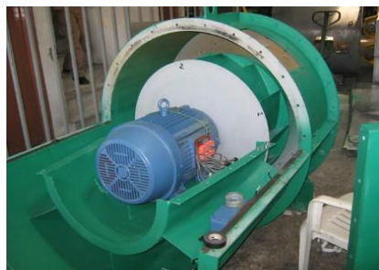
Ventilador centrífugo tubular para suministrar o extraer aire en espacios limitados, como en túneles de minas.
