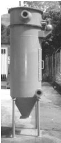
Filtros de entrada tangencial para transportes neumáticos.
