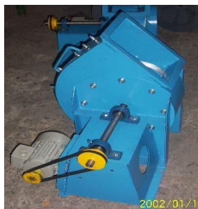
Ventiladores Centrífugos con rotores anti desgaste para materiales abrasivos.
