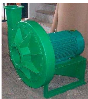
Turbinas tipo 'R' y tipo "T". Ventilador centrífugo de rotor radial, para altas presiones. Utilizado para quemadores, transportes neumáticos, etc.
