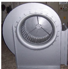
Ventiladores con aletas inclinadas hacia adelante Tipo FC.
