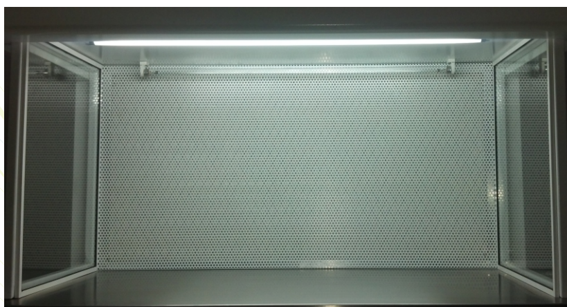
Interior de la cabina de flujo laminar
